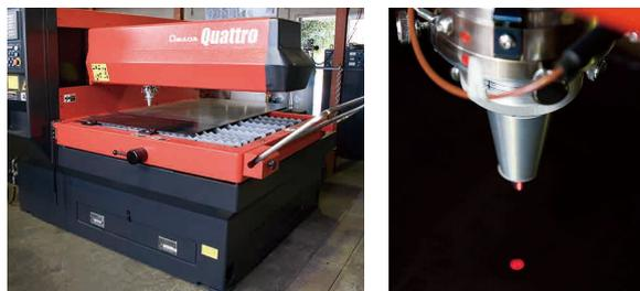
▲レーザによる銅板の精密切断
