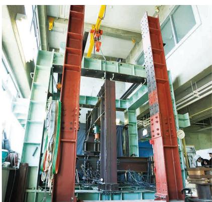
▲ 1MN級大型構造物試験装置
