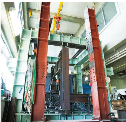
▲ 1MN級大型構造物試験装置
