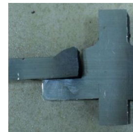
溶接接合部の疲労試験
