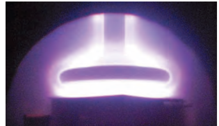
▲プラズマ中でのカーボンナノチューブの生成の様子
