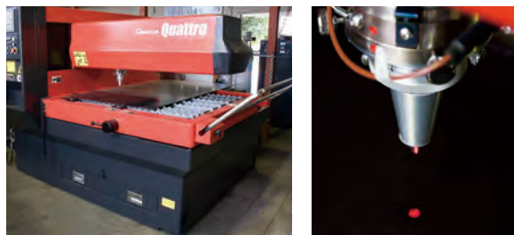
▲レーザによる銅板の精密切断
