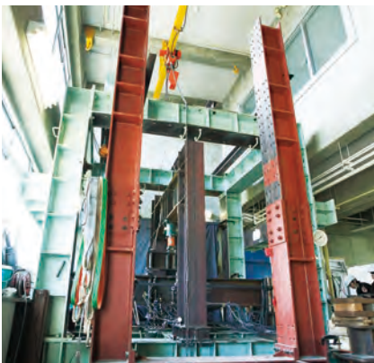
▲ 1MN級大型構造物試験装置
