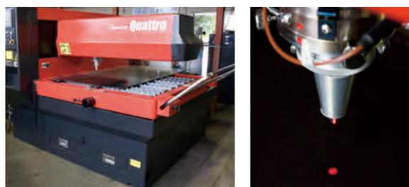
▲レーザによる銅板の精密切断
