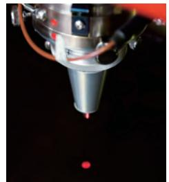
▲レーザによる銅板の精密切断
