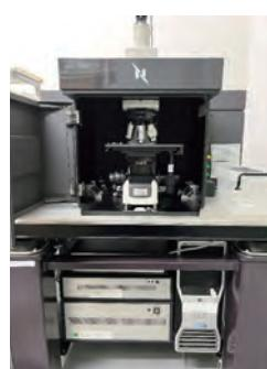
▲h-BNの結晶評価に用いる顕微ラマン散乱光分析装置
