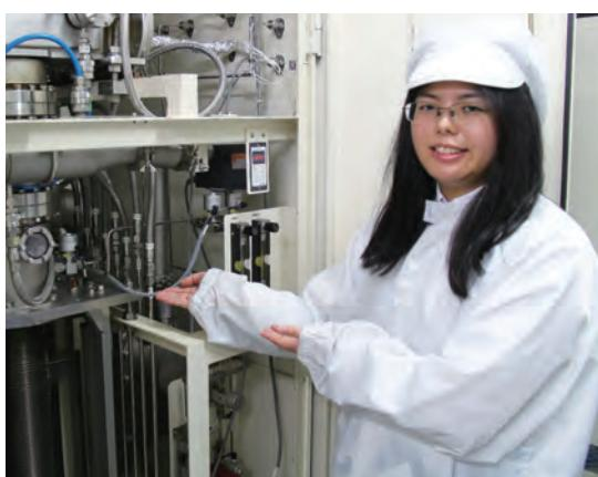
▲h-BNの結晶成長に用いた有機金属氣相成長装置(MOVPE)
