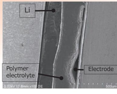
電気化学反応中に観察した電極/ポリマー
