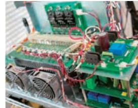
直接形AC/AC電力変換器
