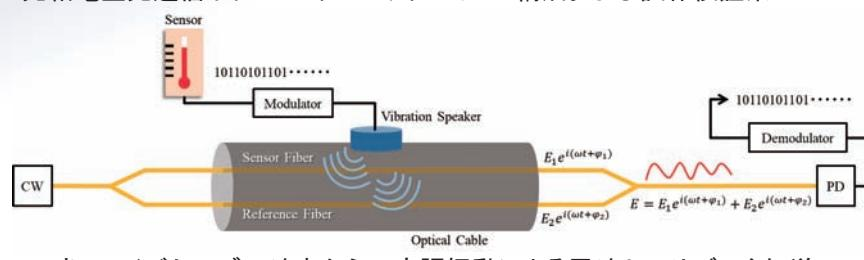
光ファイバケーブル外皮からの変調振動による屋外センサデータ伝送
