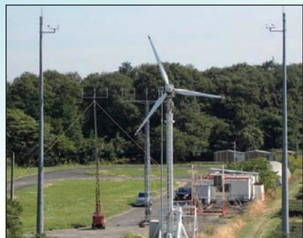
水平軸風車のフィールド実験
