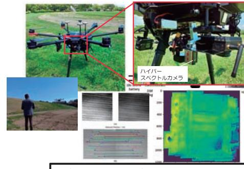
ドローンとハイパースペクトルカメラを用いた農作物の育成評価
