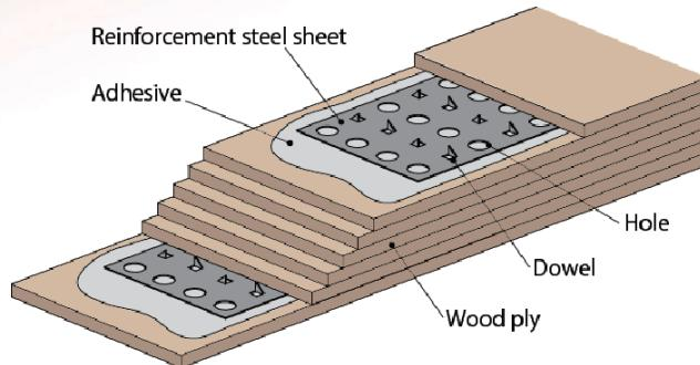
鋼板補強集成材(RWB)の開発と性能実験
