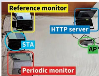
複数無線LANチャネルのスループット同時推定実験概観
