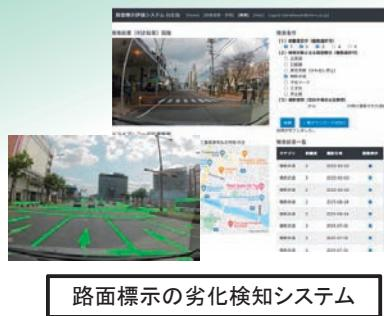
路面標示の劣化検知システム
