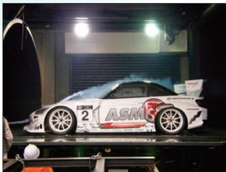
自動車に作用する空力荷重の計測
