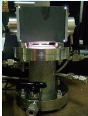
太陽光構成波長応答型光触媒CO<sub>2</sub>改質器
