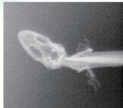
液体Li電子源を搭載したX線顕微鏡
