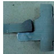
溶接接合部の疲労試験
