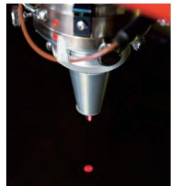
▲レーザによる銅板の精密切断
