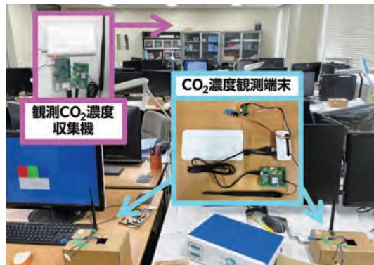
▲屋内CO<sub>2</sub>濃度観測のための無線センサネットワーク最適設計
