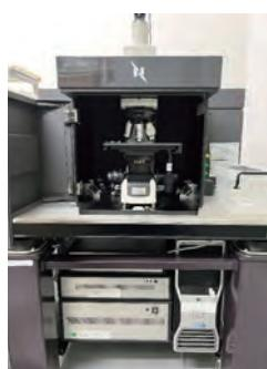
▲h-BNの結晶評価に用いる顕微ラマン散乱光分析装置
