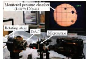
▲潤滑油1万気圧での高圧粘度計測装置
