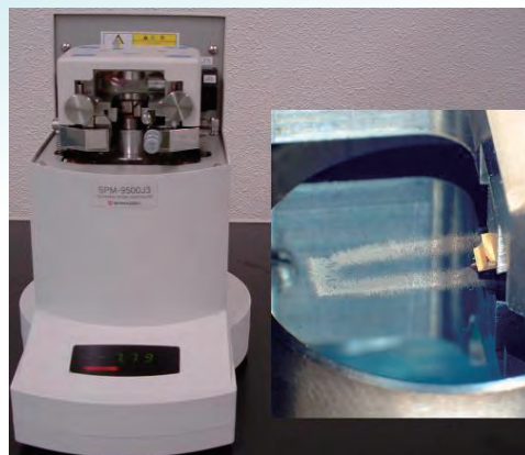
原子間力顕微鏡: 各種試料表面のナノメートルオーダーの微細な形状を測定します。
