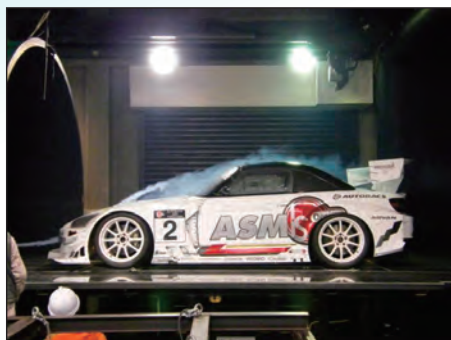
自動車に作用する空力荷重の計測
