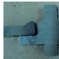
溶接接合部の疲労試験
