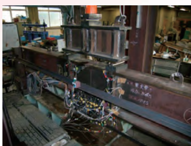
鉄骨構造高力ボルト接合部の実験
