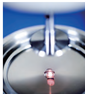
▲ 粘弾性測定装置上に滴下された試料液滴
