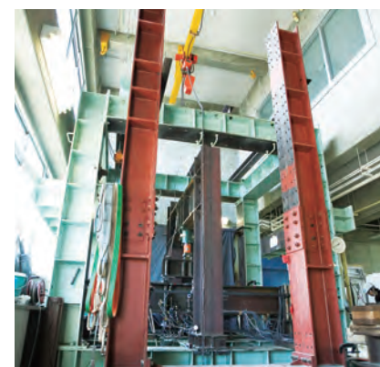
▲ 1MN級大型構造物試験装置
