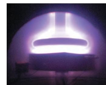
▲ プラズマ中でのカーボンナノチューブの生成の様子
