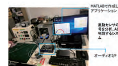
▲AIを利用した製造ラインにおける不良品判別システム
