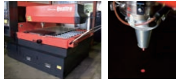
▲ レーザによる銅板の精密切断
