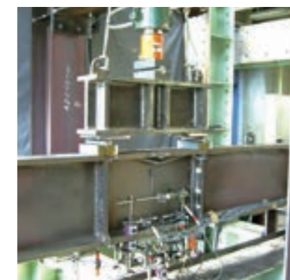
▲ 鋼構造接合部の性能実験
