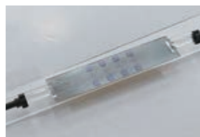
▲世界初の5G無線向け光電界センサ
