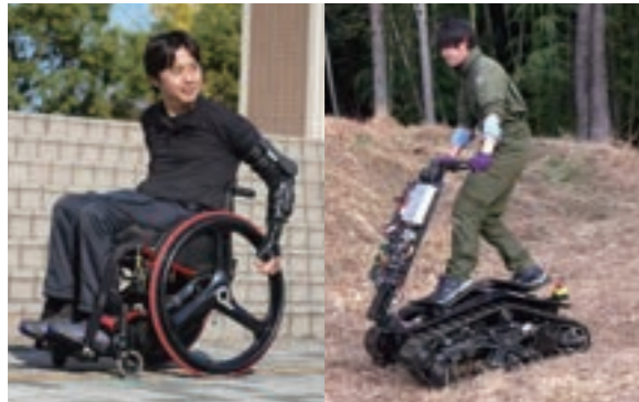
▲左: 上肢動作支援用ウェアラブルロボット 右: 不整地走行用パーソナルモビリティ
