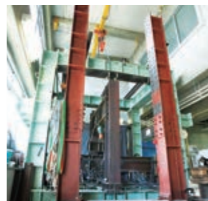
▲ 1MN級大型構造物試験装置
