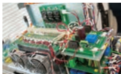
▲マトリクスコンバータ実験装置
