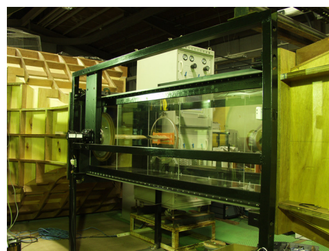
図1 風車専用翼型の風洞実験
