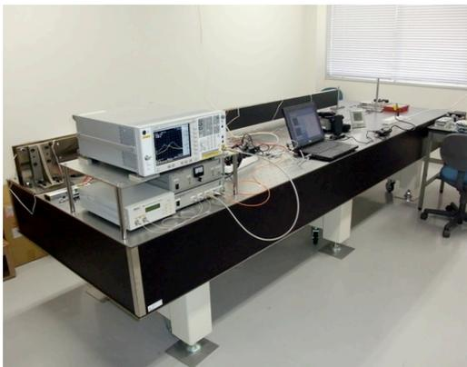
安全・安心な社会を目指して、防災・減災に役立つ光ファイバセンシングシステムの研究を行っています。このシステムは光ファイバをセンサに用い、光ファイバ内で発生するブリュアン散乱光のスペクトルがひずみや温度に依存して周波数シフトする物理現象を利用しています。情報工学をベースに機械、電子、土木などの幅広い観点から、またハードウェアとソフトウェアの両面から、システムの計測特性や性能向上にかかわる基礎的研究、変位センサなどへ応用するための研究、リモートモニタリングシステムの開発などを進めています。
