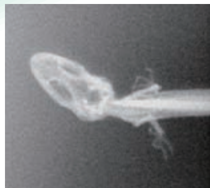
液体Li電子源を搭載したX線顕微鏡の観察例(ヤモリ、露光時間1秒)
