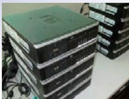
安価なPCをネットワーク接続した高性能計算サーバ
