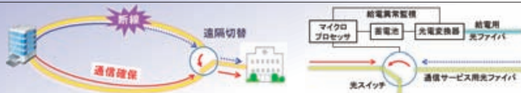
異常時に通信経路を自動切替するための光ファイバ給電システム構成例
