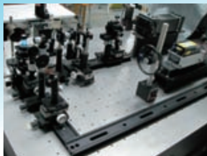
潤滑油の機械性能評価システム: レーザーを使用した、潤滑油の機械 性能評価装置です。
