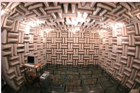
無響室(建築棟1F環境実験室内)
