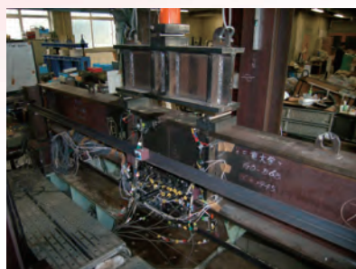
鉄骨構造高力ボルト接合部の実験
