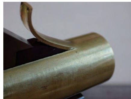
管材の切り粉レスな軸方向切断工法
