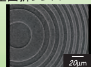
電子線描画装置で作製した焦点分布制御型回折レンズ
