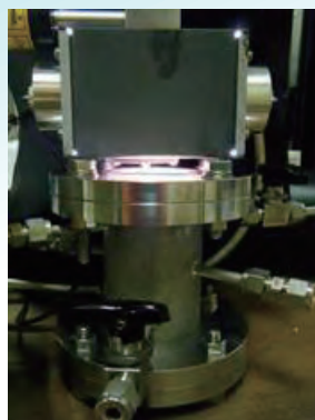
太陽光構成波長応答型光触媒CO 2 改質器
