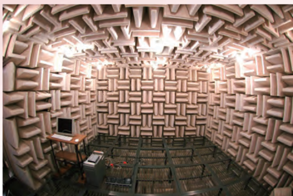
無響室(建築棟1F環境実験室内)
