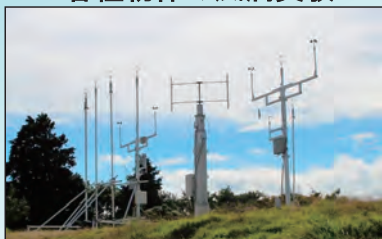
垂直軸風車のフィールド実験
