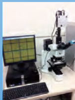
顕微鏡LED露光ユニット
