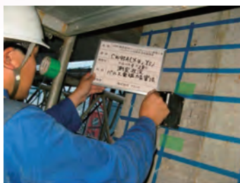
パルス電磁力音響法
