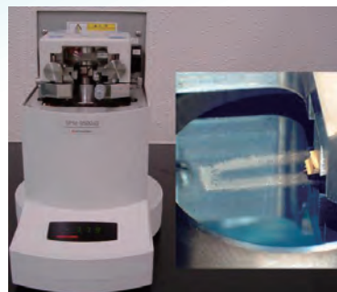
原子間力顕微鏡: 各種試料表面のナノメートルオ ーダの微細な形状を測定しま す。
