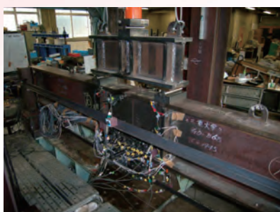
鉄骨構造高力ボルト接合部の実験
