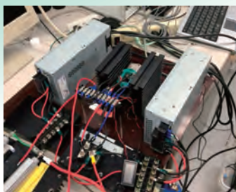
燃料電池模擬装置
