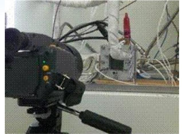
固体高分子形燃料電池の非接触温度測定
