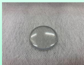
3Dプリンターで作製した平凸レンズ
