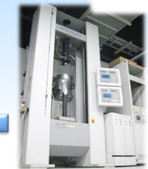
高温炉付複合負荷試験機 各種温度条件下での 理想的な2軸応力状態で 新素材の強度や変形を評価
