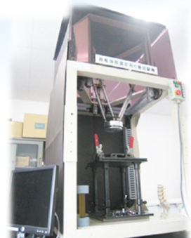
六軸力学評価装置 自由度の高い動作で 生体器官やインプラントの 特性・機能を計測
