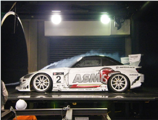
自動車に作用する空力荷重の計測
