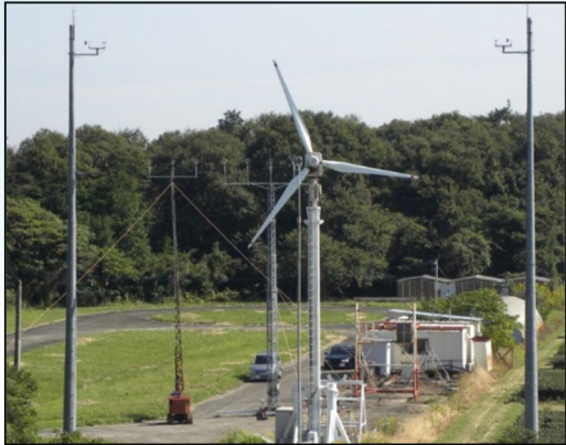
水平軸風車のフィールド実験
