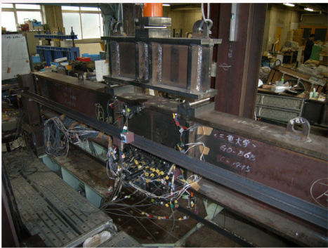
鉄骨構造高力ボルト接合部の実験
