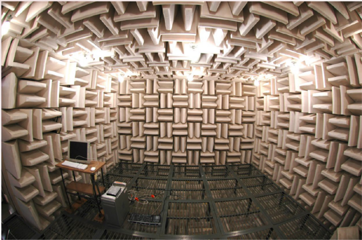
無響室(建築棟1F環境実験室内)
