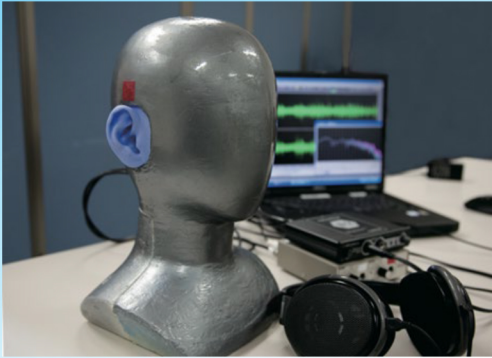
音や振動を計測し分析するための装置やソフトの一例です。
