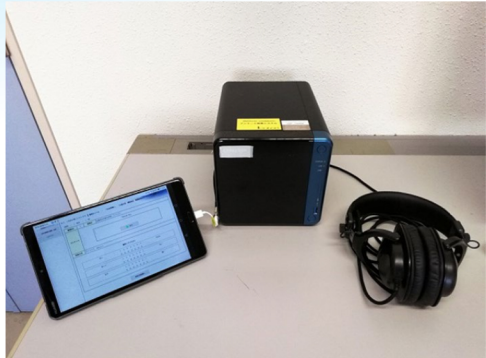
音(映像を含む)の官能評価をインターネットを利用して遠隔地でも実施できるようにした実験システムです。
