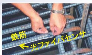
共同開発した埋込みタイプのコンクリート用センサと鉄筋への固定
