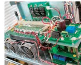
直接形AC/AC電力変換器
