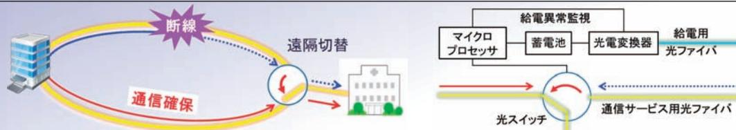
異常時に通信経路を自動切替するための光ファイバ給電システム構成例
