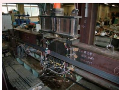
鉄骨構造高力ボルト接合部の実験
